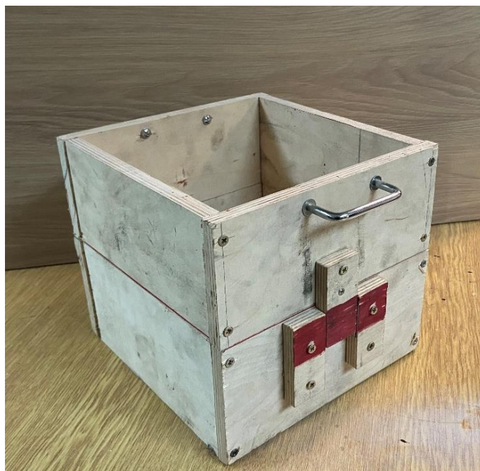
Slika 7.6 Spojeni okvir kalupa
