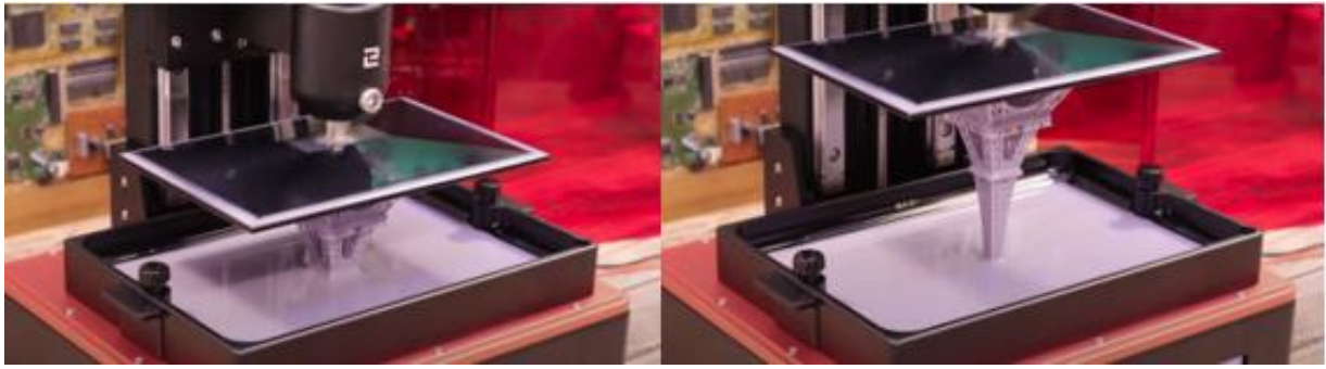
Slika 6.7 Tijek printanja SLA printera
