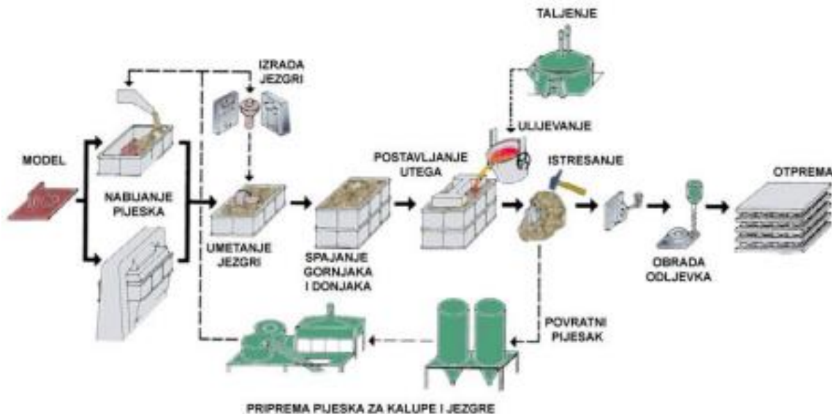
Slika 5.6 Proizvodni proces u ljevaonici [8]
