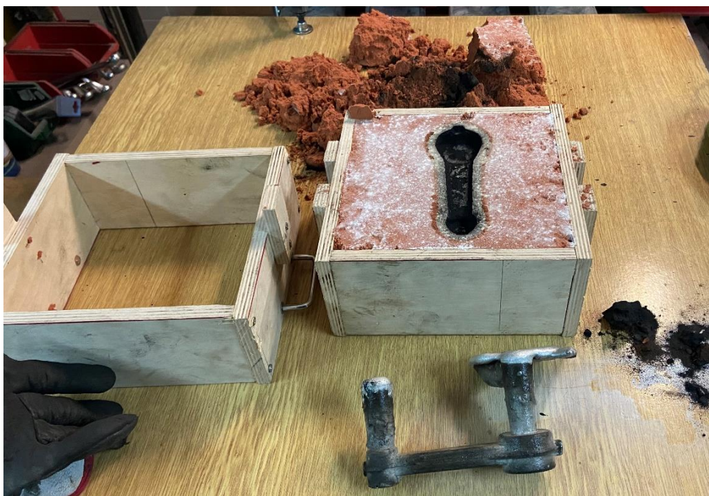
Slika 7.13 Izvađen odljevak iz kalupa
