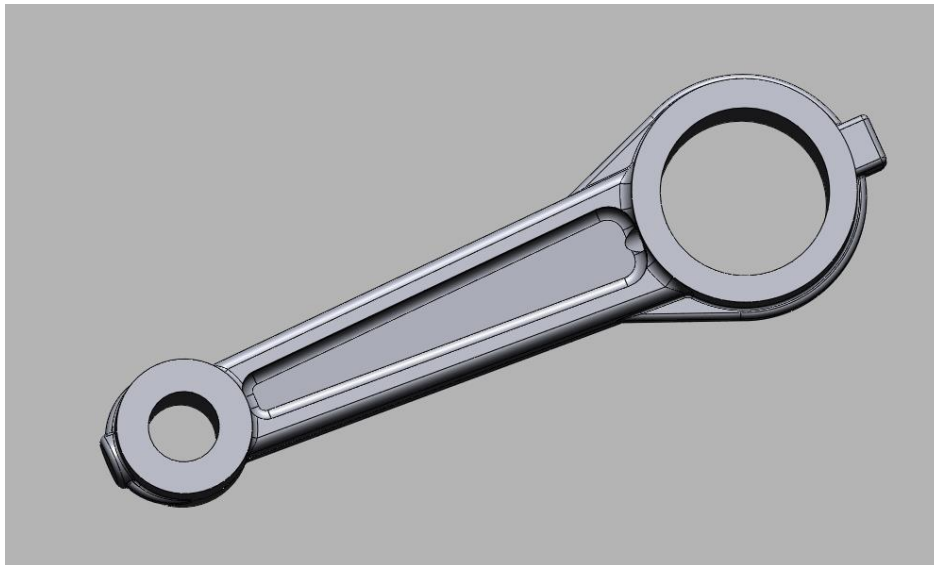
Slika 4.17 CAD model klipnjače
