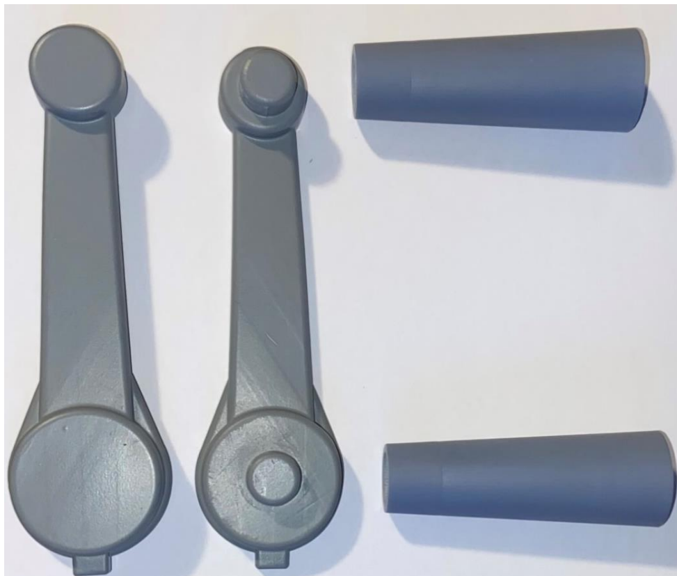
Slika 7.2 Pojednostavljeni model za lijevanje
