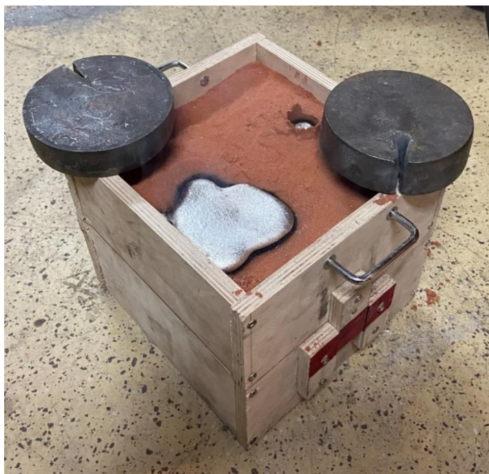
Slika 7.12 Hlađenje taline u kalupu
