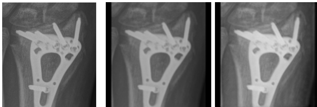
(a) Slika prije rekonstrukcijskog modela (b) UNet, stopa učenja \alpha = 0.0001 (c) AttentionUNet, stopa učenja \alpha = 0.00001
