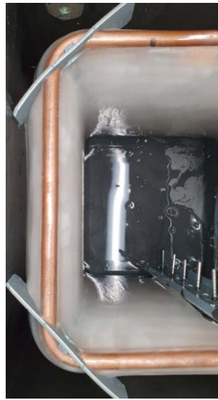
Slika 40. Zaliha leda nominalne konfiguracije rashladnog uređaja
