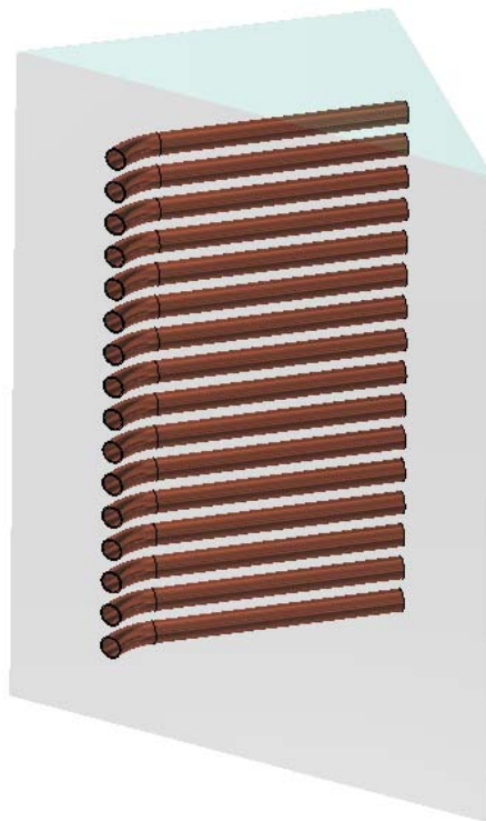
Slika 26. Osmina rashladne kupke s isparivačem
