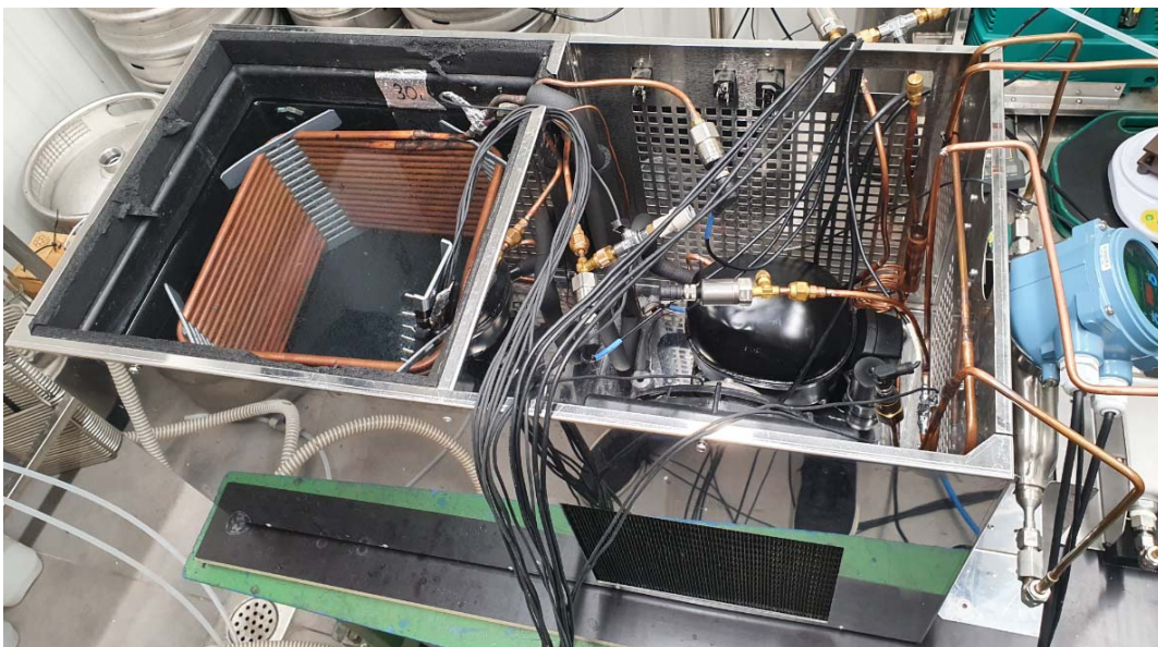
Slika 9. Ispitni uzorak premix rashladnog uređaja
