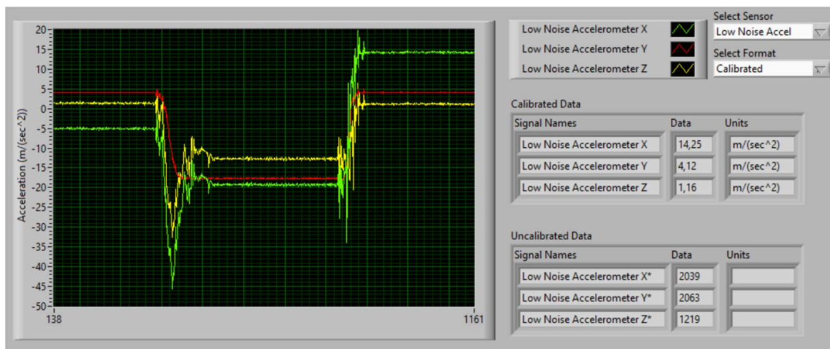
Slika 3.11. Graf analize kalibriranih podataka za akcelerometar
