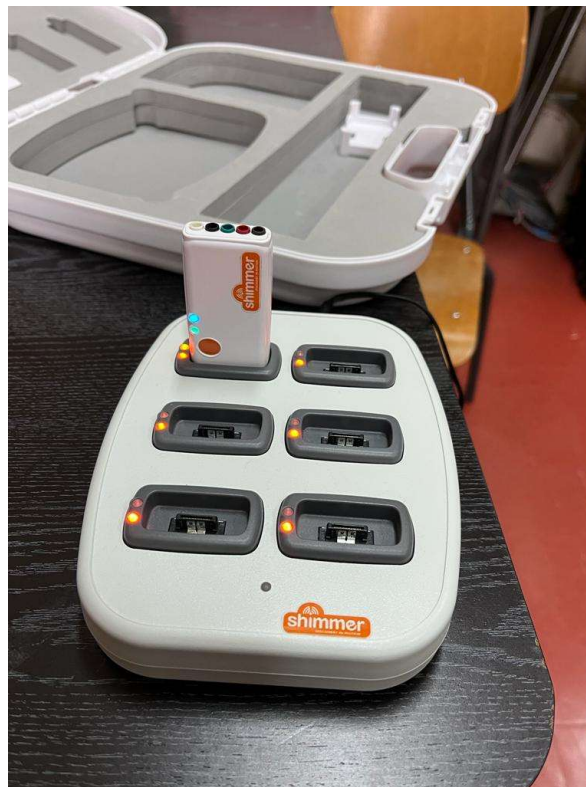
Slika 3.4. Shimmer Dock sa senzorom na punjenju
