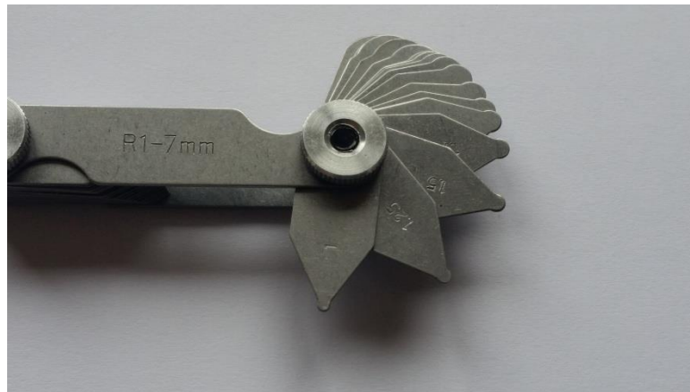
Slika 4.3. Lisnato mjerilo za mjerenje radijusa
