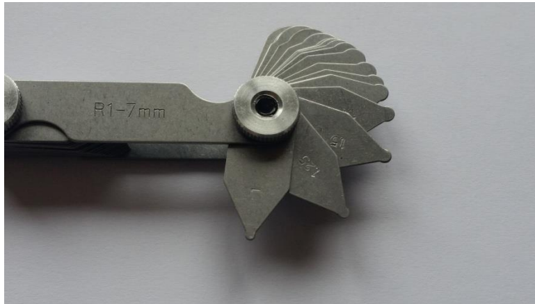
Slika 4.3. Lisnato mjerilo za mjerenje radijusa
