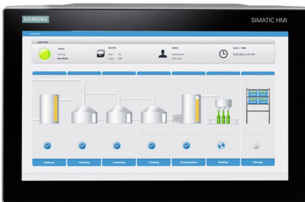
Slika 3.4. Siemens HMI ekran [19]
