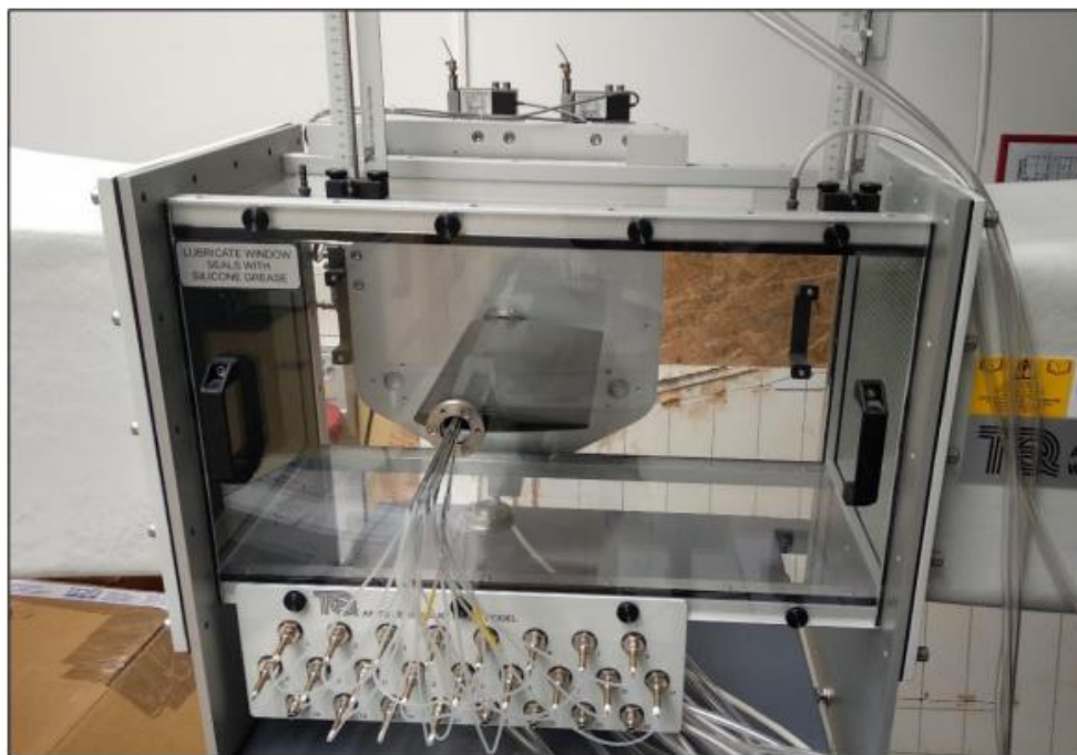
Slika 5.2. Testna sekcija zračnog tunela [3]
