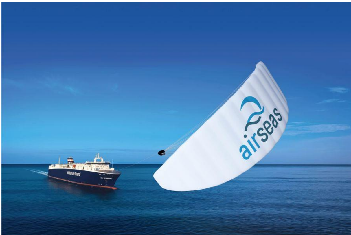
Slika 13. Prikaz plovnog objekta sa zmajevima za vuču [25]
