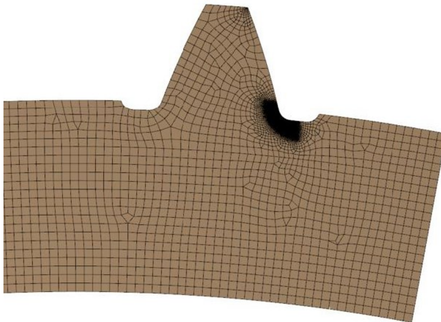
Slika 4.2. Diskretizacija zuba zupčanika mrežom konačnih elemenata [6]
