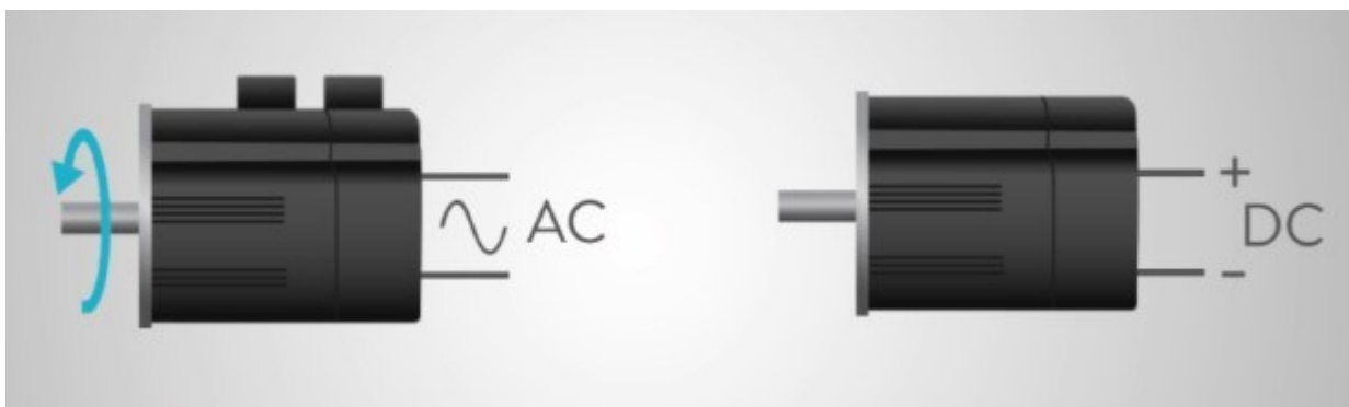
Slika 3.2: AC i DC servo motor [5]
