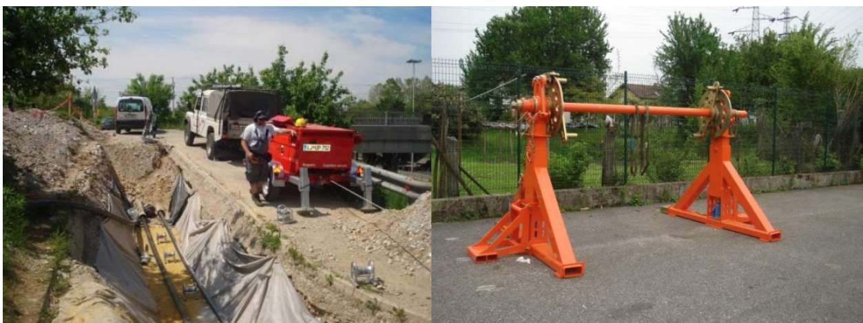
Slika 4.9. Vučno vitlo i postolje za kabelski bubanj[1]
