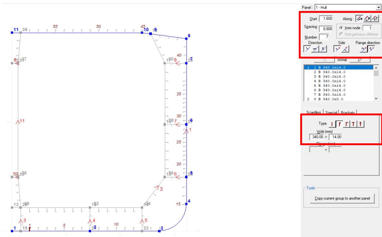
Slika 5.6. Prikaz postavljenih uzdužnjaka
