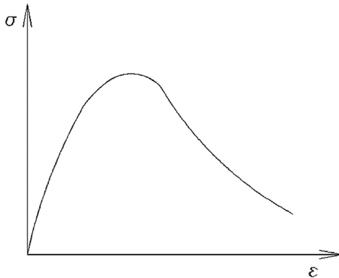
Slika 3.6. Krivulja naprezanja-deformacije za slom uslijed gredno-štapnog izvijanja [4]
