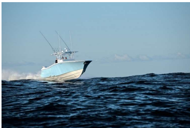
Slika 1.1.3.1. Go-Fast brod sa središnjom konzolom [10]
