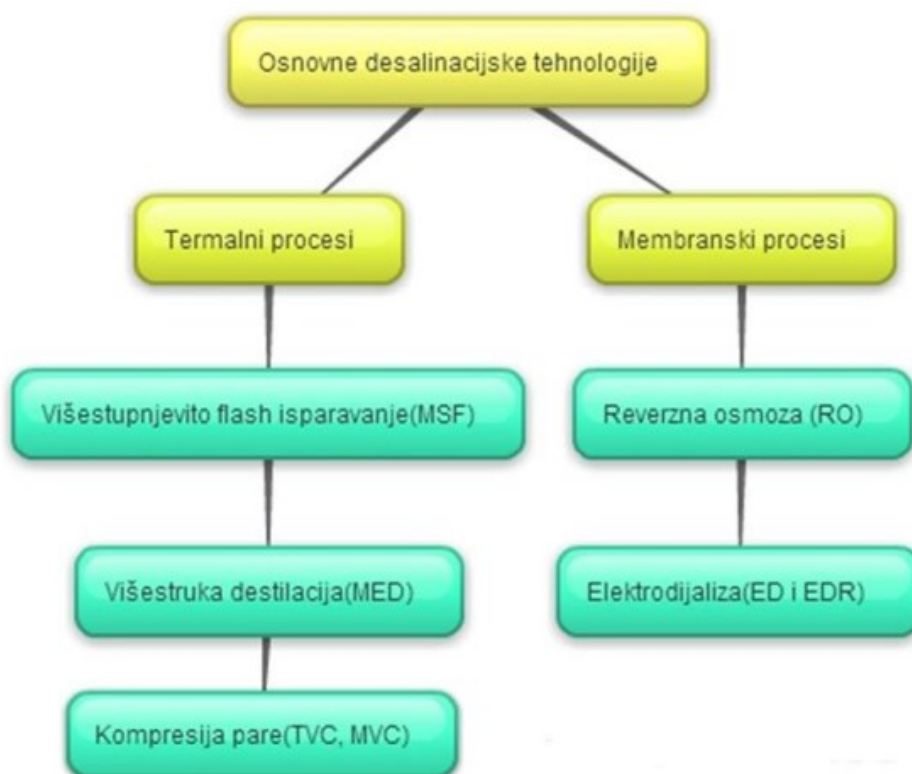
Slika 3.2. Shematski prikaz osnovnih desalinizacijskih tehnologija [5]
