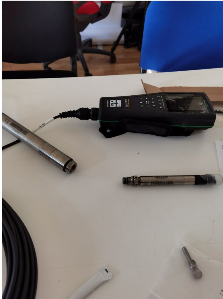
Slika 4.2. Spajanje Pro Logger-a s senzorom saliniteta i elektroprovodljivosti
