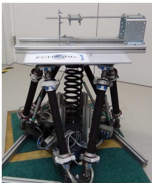
Slika 2.5 Stewartova platforma pogonjena pneumatskim mišićima [10]
