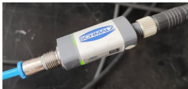
Slika 4.5 Schmalz VS VP8 SA M8-4 senzor tlaka
