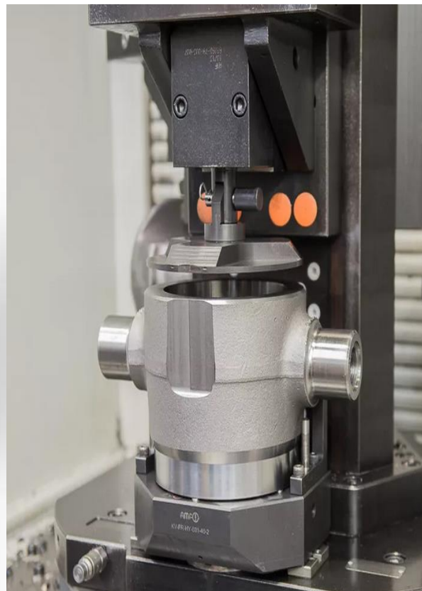
Slika 2.4. i 2.5. – Hidrauličke stezne naprave [10]
