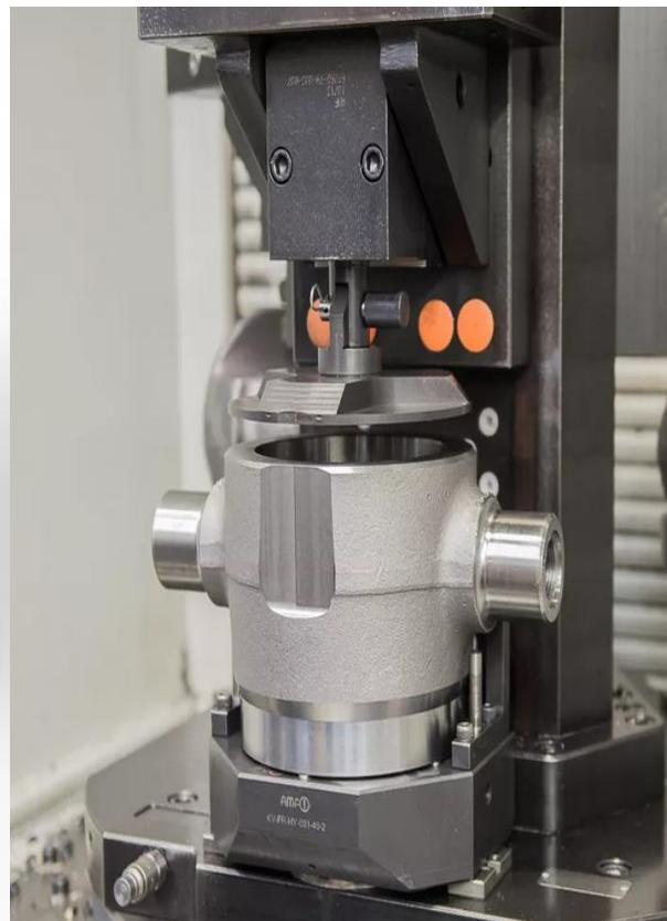
Slika 2.4. i 2.5. – Hidrauličke stezne naprave [10]
