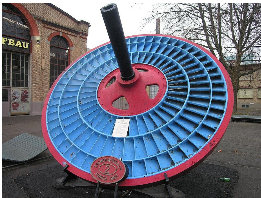
Slika 2.15. Rotor Jonval-ove turbine [21]
