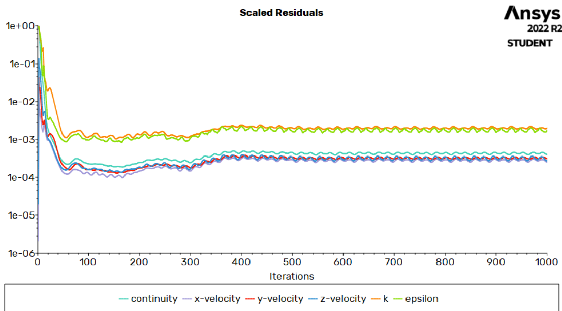
Slika 6.2. Graf konvergencije originalnog difuzora
