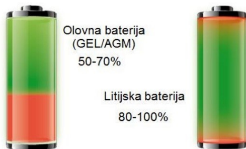
Slika 8: Usporedba olovnih i litijskih baterija u odnosu na njihovu iskoristivosti energije [6] 12
