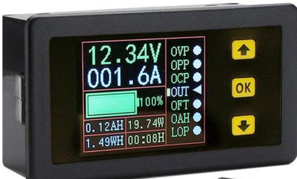
Slika 6.1. Nadzornik baterije za OFF GRID
