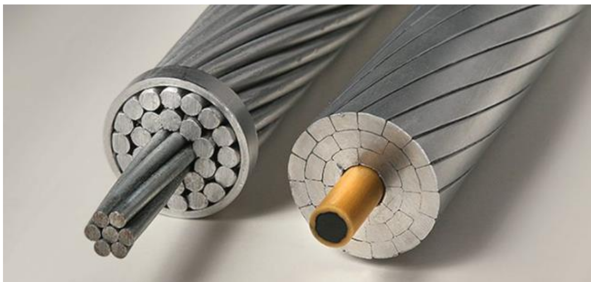
Slika 2.14. Visokotemperaturni ACCC vodiči s kompozitnim jezgrama: okrugla struktura (lijevo), trapezoidna struktura (desno) [22]
