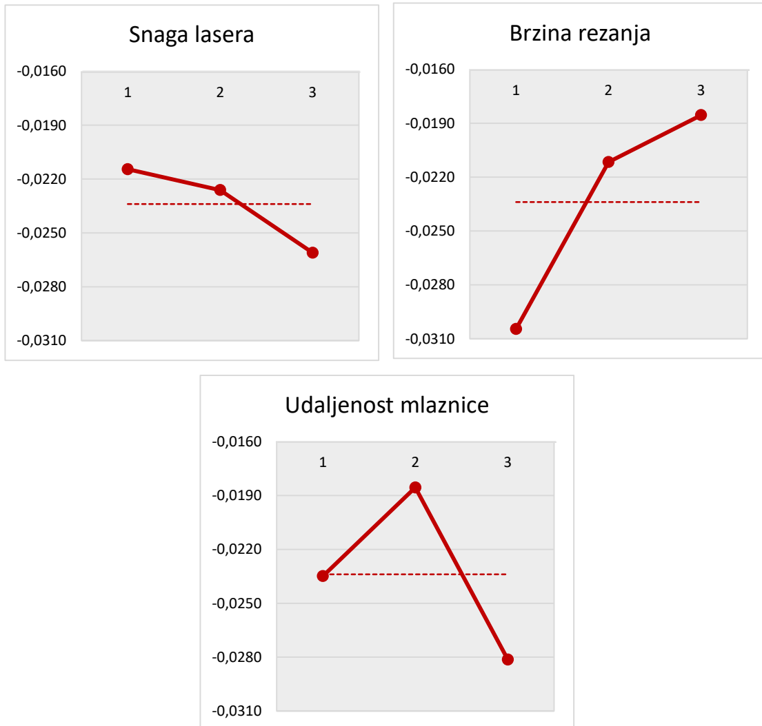
Slika 7.4. Utjecaj čimbenika na dimenzijsku točnost
