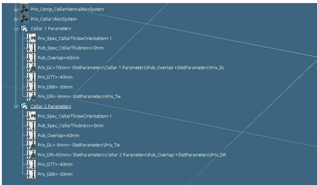
Slika 6.18. Parametri definicije konture generičkog prolaza profila „P3-HP160x8“, 3.dio
