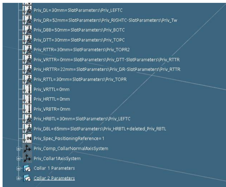
Slika 6.22. Parametri definicije konture generičkog prolaza profila „P4-HP160x8“, 2.dio
