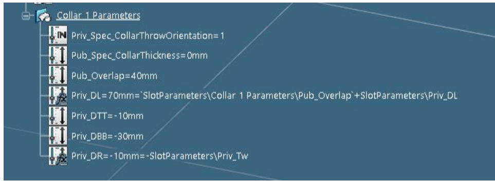
Slika 6.41. Parametri definicije konture generičkog prolaza profila „P11-FB150x10“, 3.dio
