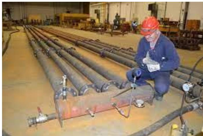
Slika 22. Princip tlačenja cjevovoda u radioni
