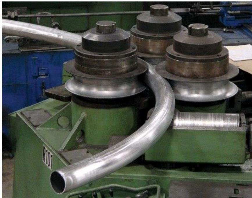
Slika 9. Savijanje cijevi na hladno
