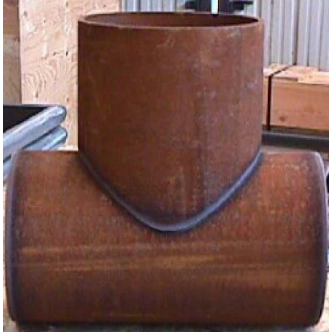
Slika 13. Detalj prodora dviju cijevi
