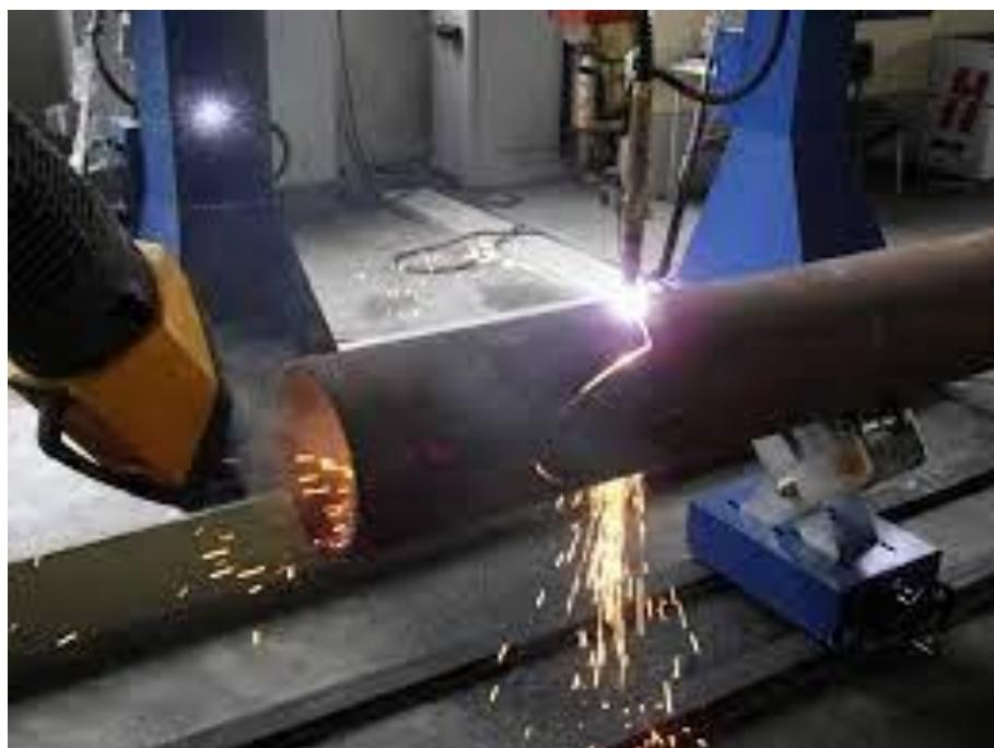
Slika 3. Strojno rezanje cijevi
