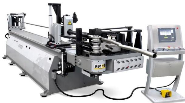
*Slika 10. CNC stroj za savijanje cijevi*
