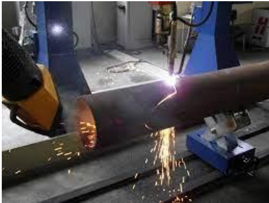
Slika 3. Strojno rezanje cijevi
