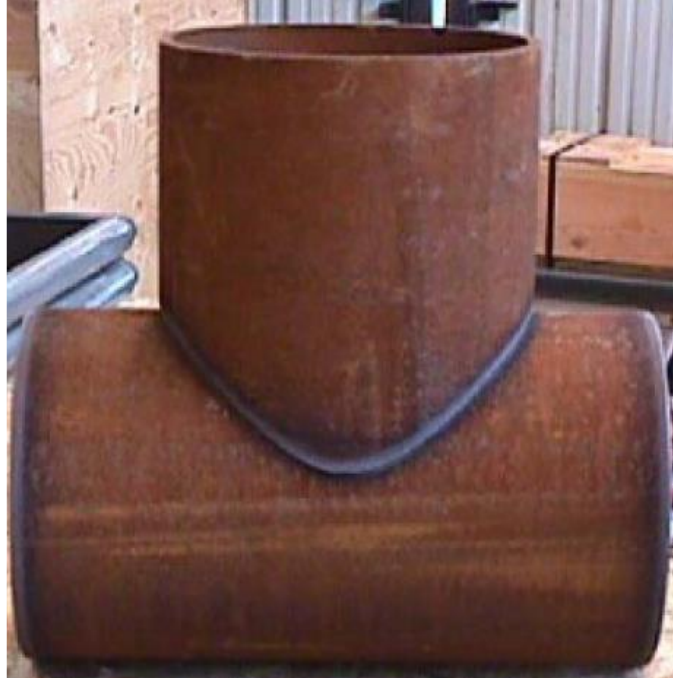
Slika 13. Detalj prodora dviju cijevi
