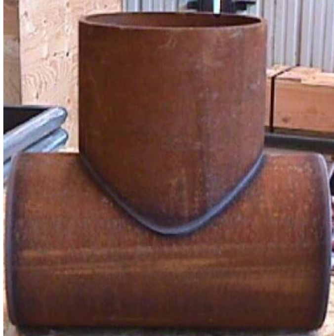
Slika 13. Detalj prodora dviju cijevi
