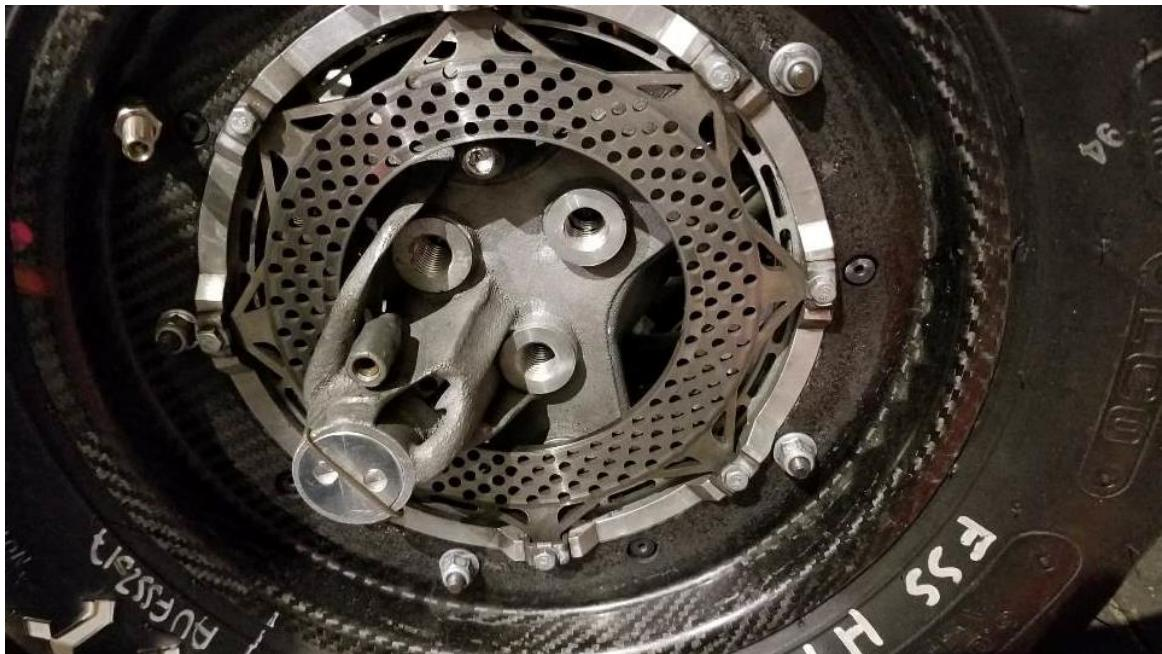
Slika 4.4 Sklop kotača: TU FAST Racing
