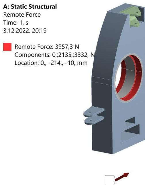
Slika 6.5 Lateralno i vertikalno opterećenje na optimizacijski model
