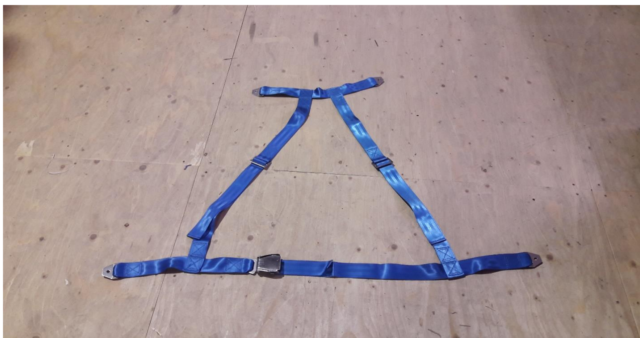
Slika 15. Sigurnosni pojas podesiv u 4 točke
