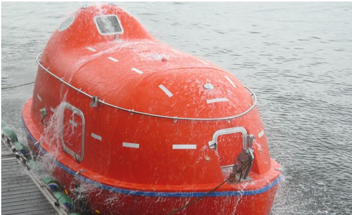
Slika 8. Brodica otporna na vatru
