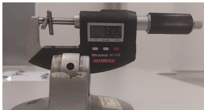
Slika 5.8 Mjerenje predmeta 1 s digitalnim mikrometarskim mjerilom
