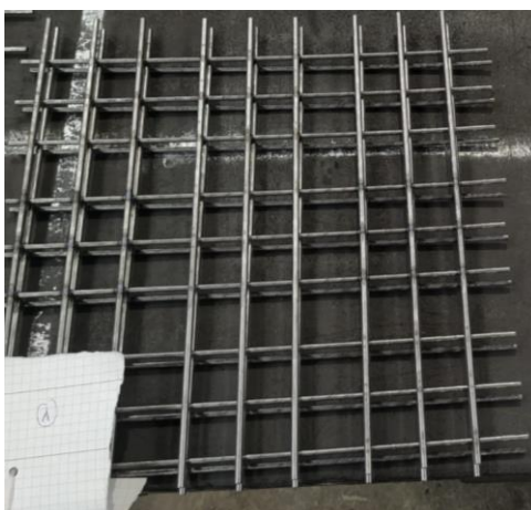
Slika 5.1 Grupa 1, žice različitih promjera spojene elektrootpornim zavarivanjem
