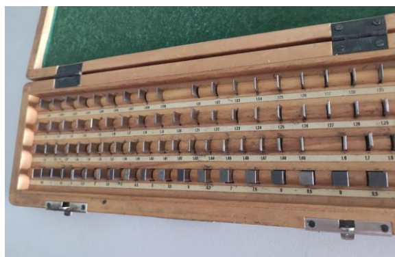
Slika 4.4 11 planparalelnih graničnih mjerki nazivnih duljina od 5 mm do 20 mm
