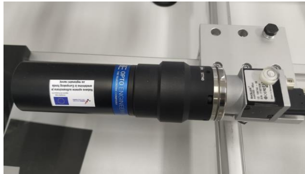
Slika 3.23 Spojeni sustav senzora i telecentričnog objektivu
