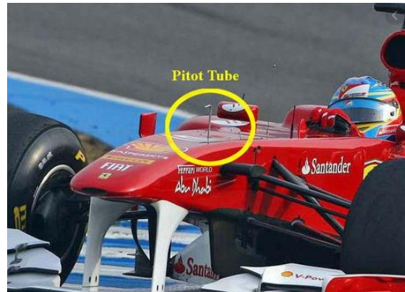
Slika 4.6. Pitotova cijev na formuli [9]
