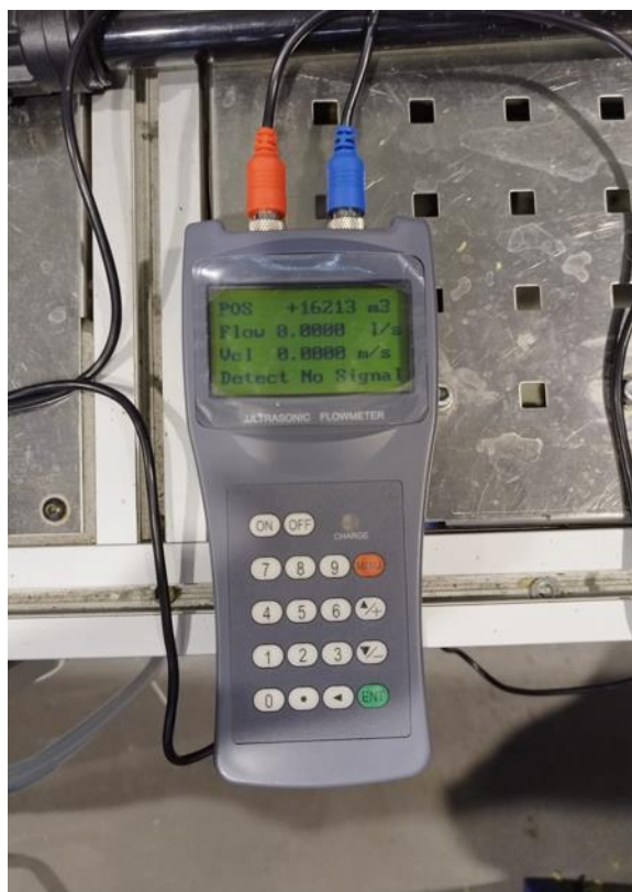
Slika 5.1. Ultrazvučni mjerač protoka
