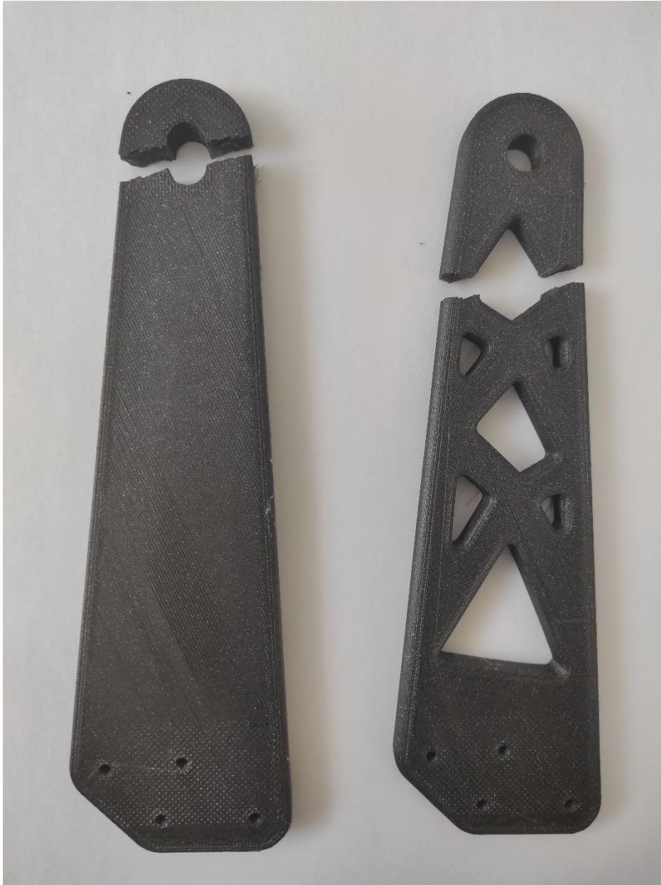
Slika 5.4.3. Uzorci nakon ispitivanja
