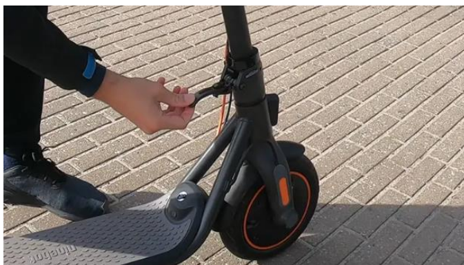
Slika 2.11.1. Stup upravljača sa sklopivim mehanizmom [18]
