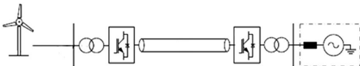
Slika 4.14. VSC HVDC prijenosni sustav [12]
