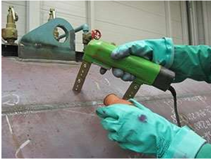
Slika 3.12. Ispitivanje zavarenog spoja magnetskim jarmom [16]
