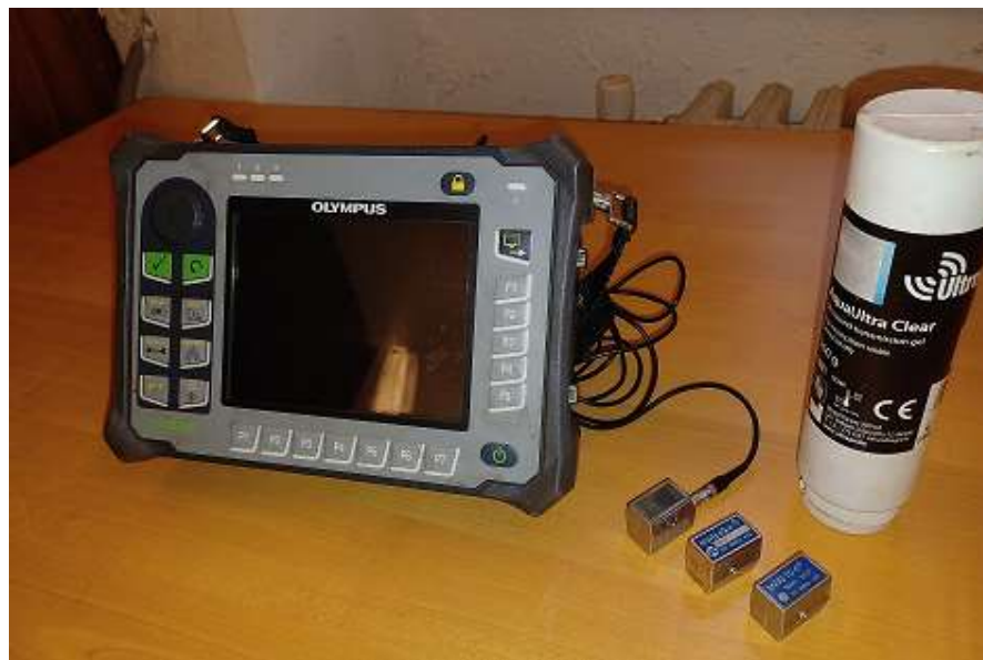
Slika 4.9. Ultrazvučni aparat OLIMPUS EPOCH 650
