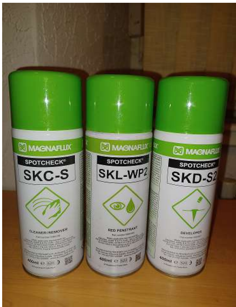
Slika 4.4. Čistač, crveni penetrant i razvijatelj
