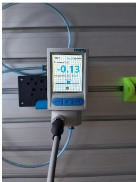
Slika 5.2 Proporcionalni regulator tlaka VPPI-5L-3-G18-1V1H-V1-S1D
