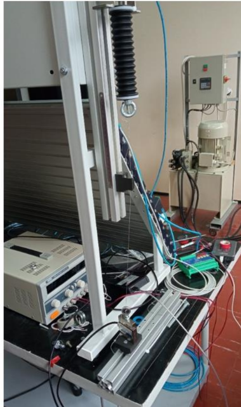
Slika 4.3 Prikaz montaže mišića i povezanosti sa senzorom
