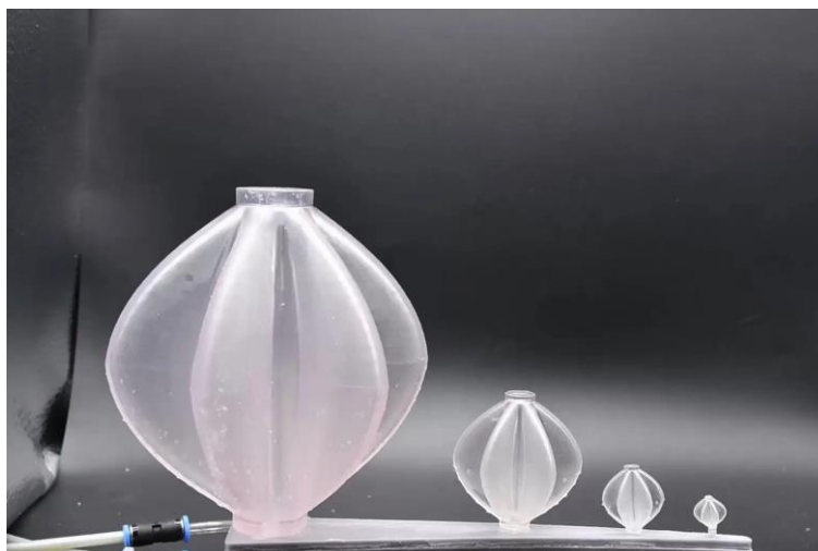
Slika 2.4 GRACE pneumatski aktuator [8]
