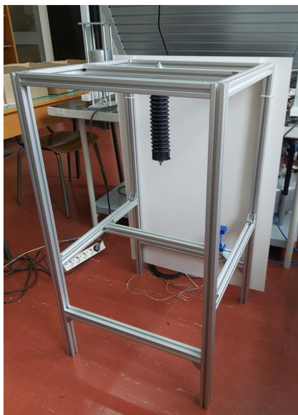
Slika 5.6 Konstrukcija za ispitivanje pneumatskog mišića
