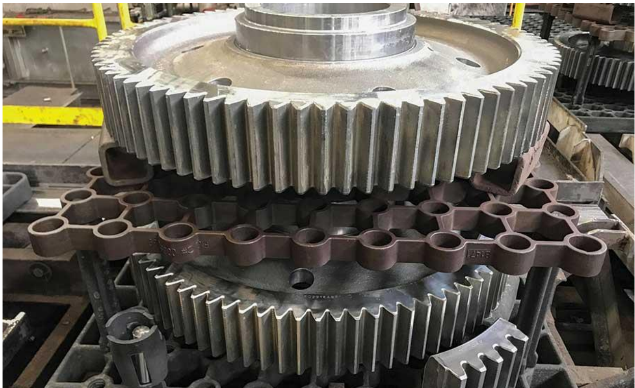
Slika 3.1. - Zupčanici stroja izrađeni od cementiranog čelika [12]
