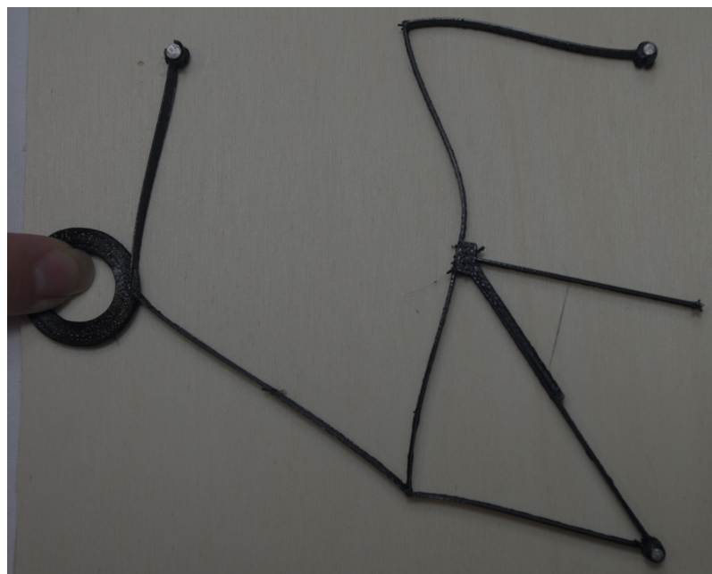
Slika 6.36 Slika prikazuje deformirani prototip odabranog mehanizma izrađen na 3D pisaču. Uspoređujući dobiveni rezultat dizajna podatljivog mehanizma i isprintani mehanizam vidljivo je kako su fizikalni aproksimirani model i strukturalni proračun pravilno predvidjeli ponašanje fizikalnog modela.
