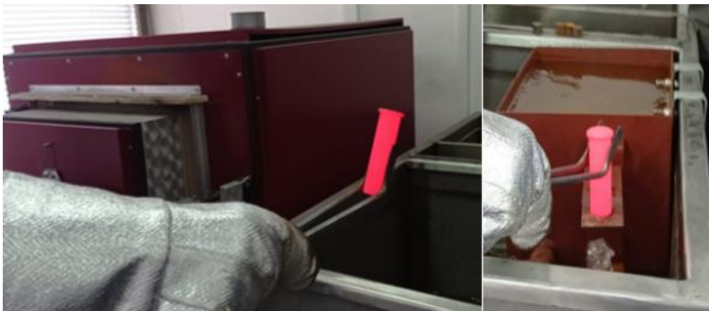
Slika 6.5 Postavljanje zagrijanog ispitnog uzorka iz peći u držač naprave za gašenje
