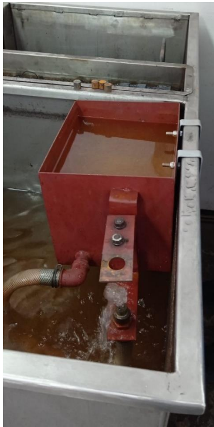
Slika 6.4 Naprava za gašenje ispitnog uzorka
