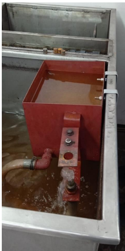
Slika 6.4 Naprava za gašenje ispitnog uzorka
