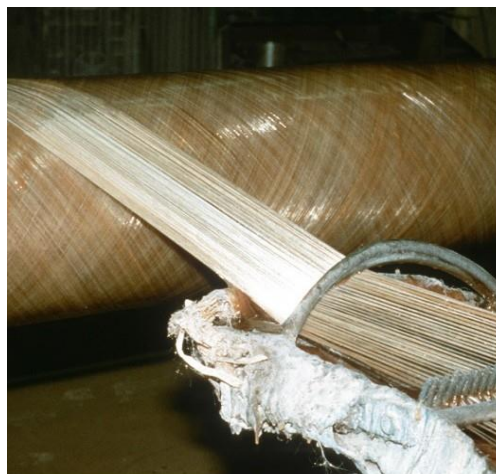
Slika 2. Stakloplastična cijev ojačana staklenim vlaknima [3]
