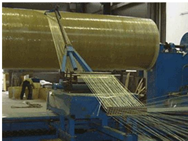
Slika 11. Filament winding metoda [18]
