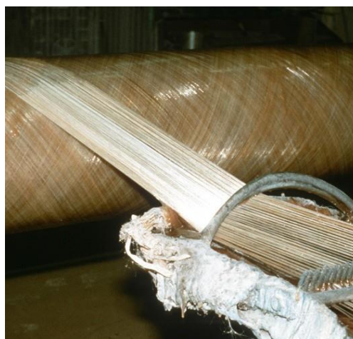
Slika 2. Stakloplastična cijev ojačana staklenim vlaknima [3]
