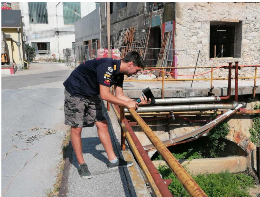
Slika 5.7 Mjerenje površinske brzine vode
