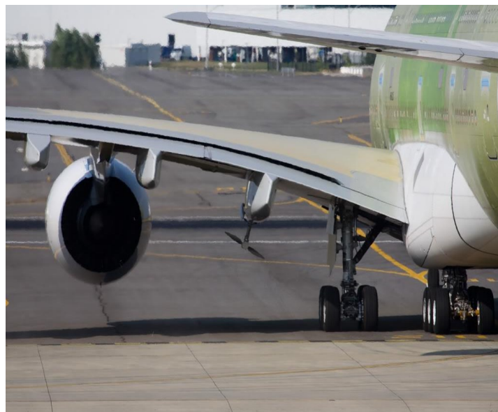
Slika 2. 2. Ram zračna turbina u radu [5]
