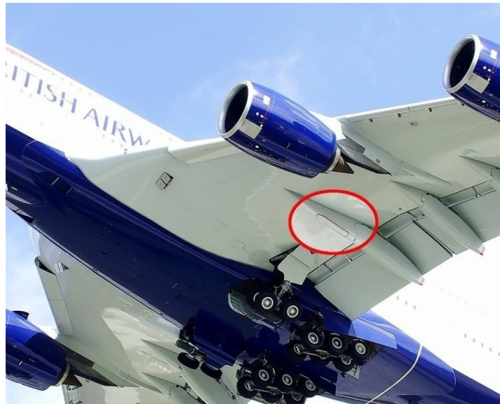
Slika 2. 1. Kućište ram zračne turbine [4]
