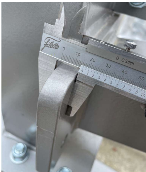
Slika 3.6 Debljina podloge vijčanog spoja nosive konstrukcije platforme
