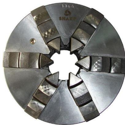
Slika 2.2. Primjer stezne glave (amerikanera) [2]
