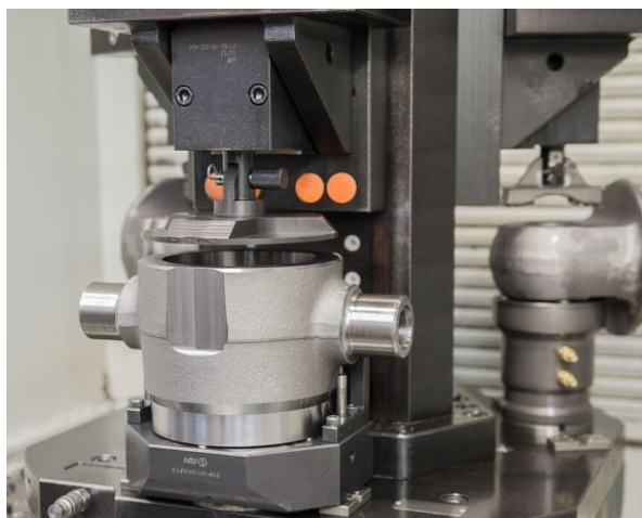
Slika 2.4. Prikaz hidrauličkog stezanja pomoću hidrauličke stezne naprave [4]
