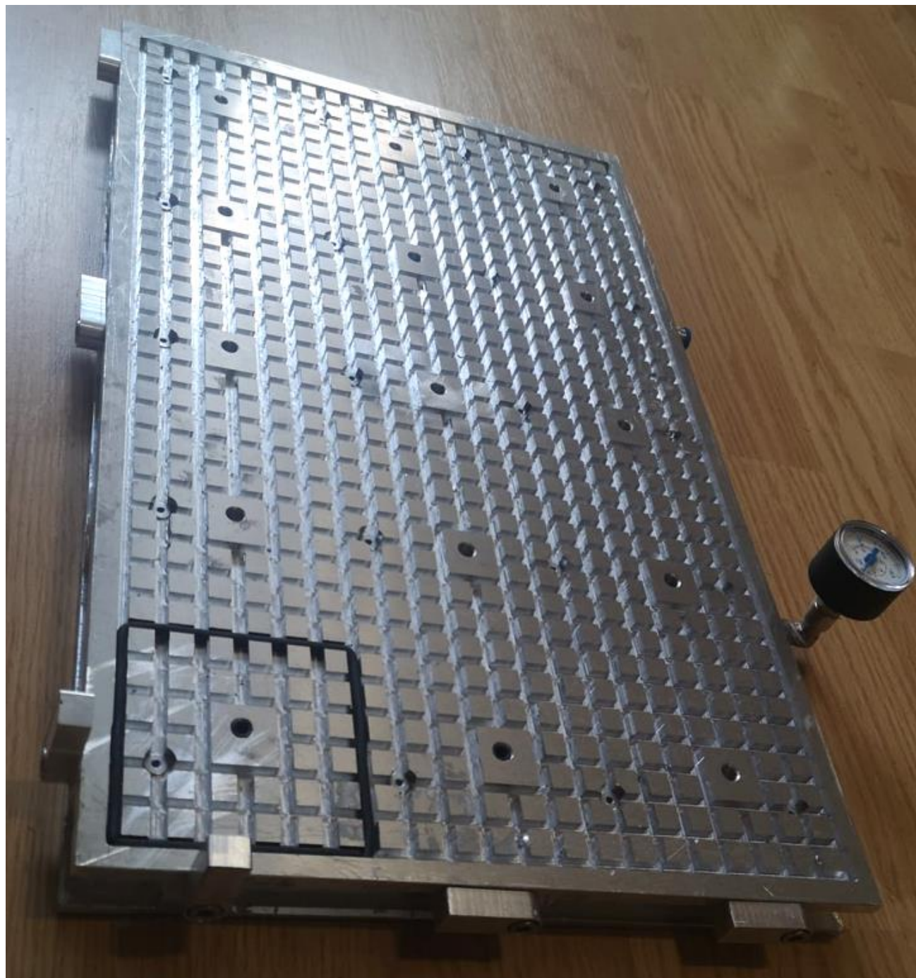
Slika 7.6. Izrađen vakuumski stol
