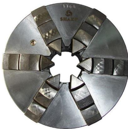
Slika 2.2. Primjer stezne glave (amerikanera) [2]
