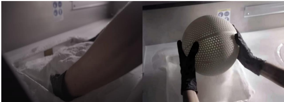
Slika 3. 8. Wilson “Airless” prototip načinjen SLS tehnologijom [54]
