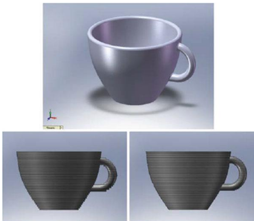
Slika 5-5.1-1 Prikaz CAD modela predmeta (gore) i aproksimacija predmeta bazirana na principu rada ne temelju slojeva (dolje). Na donjim slikama vidi se razlika u točnosti aproksimacije predmeta kada je primarni sloj deblji (lijevo) i tanji (desno) [8]
