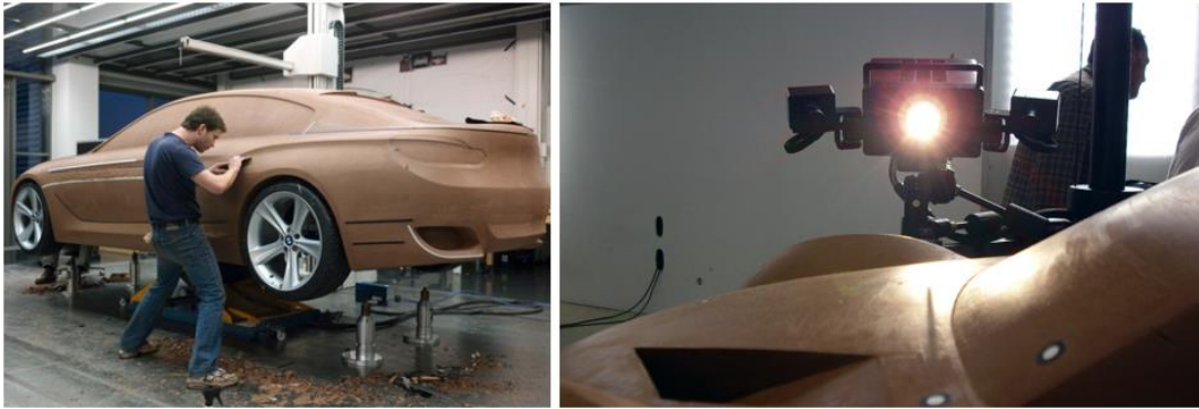
Slika 3-1 Izrada prototipa automobila u glini [10]
