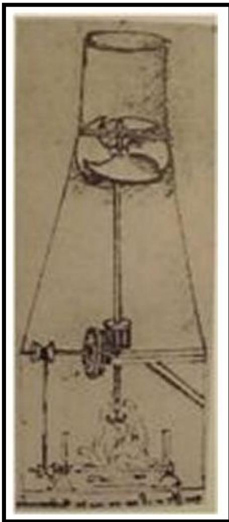
*Slika 2.2. da Vincijeva turbina*
