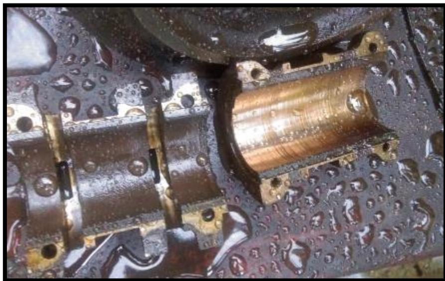
*Slika 3.9. Rastavljeni ležaj turbine*
