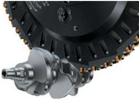
Slika 3.8 Glodalo za koaksijalno tokarsko glodanje koljenastih osovina [8]
