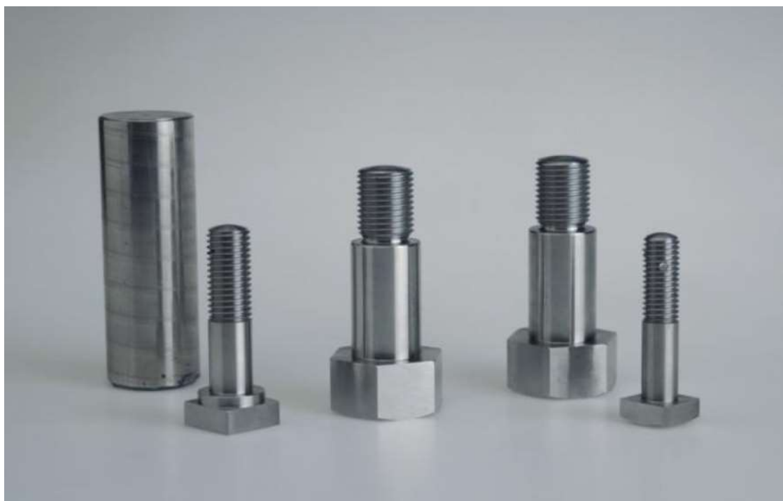
Slika 2.1 Šesterokutne glave vijaka izrađene postupkom poligonalnog tokarenja
