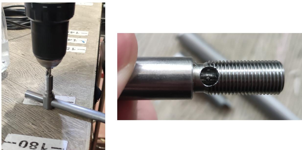
Slika 4.33. Bušenje spojnog vijka (lijevo); spojni vijak (desno)
