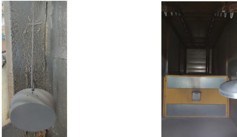
Slika 4.30. Prah na komadu (lijevo) i peć (desno)
