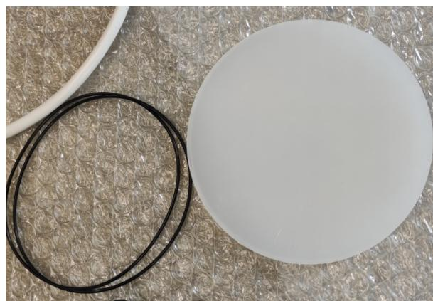
Slika 3.38. O-ring i akrilno staklo nakon tokarenja
