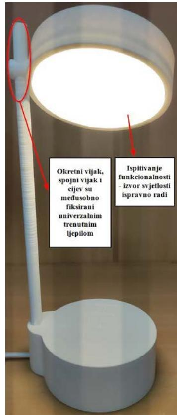
Slika 3.43. Sklop prototipa - izvor svjetlosti
