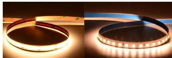
Slika 2.11. COB na LED traci (lijevo) i SMD čip (desno) [22]
