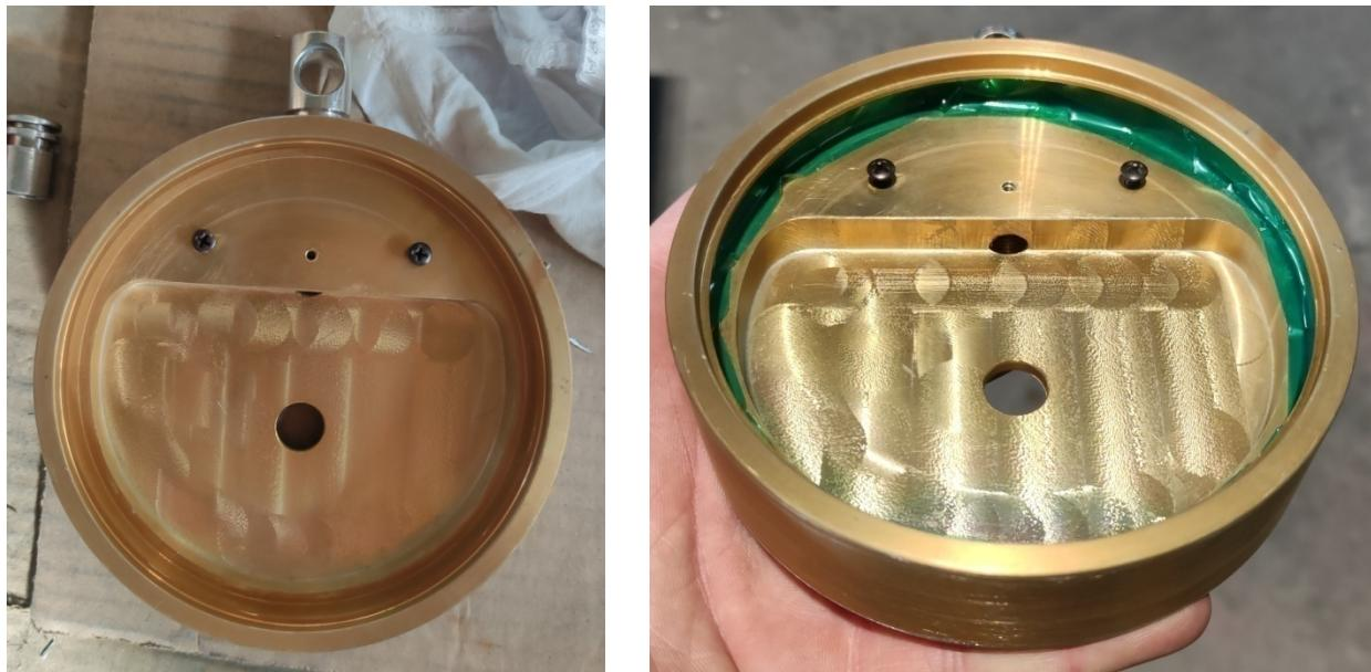
Slika 4.38. Kromatirana glava i poinčani okretni vijak (lijevo); ljepljenje trake za sprječavanje plastificiranja (desno)
