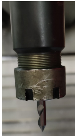
Slika 4.40. Graver koji se koristio za graviranje gravura
