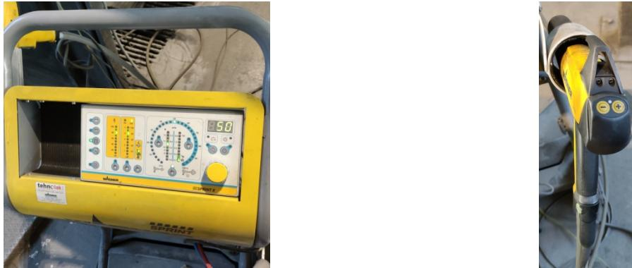
Slika 4.29. Uređaj i pištolj za ručno nanošenje praha
