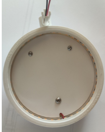
Slika 3.40. Poklopac za zatvaranje prostora s dekorativnom elektronikom
