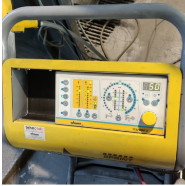
Slika 4.29. Uređaj i pištolj za ručno nanošenje praha
