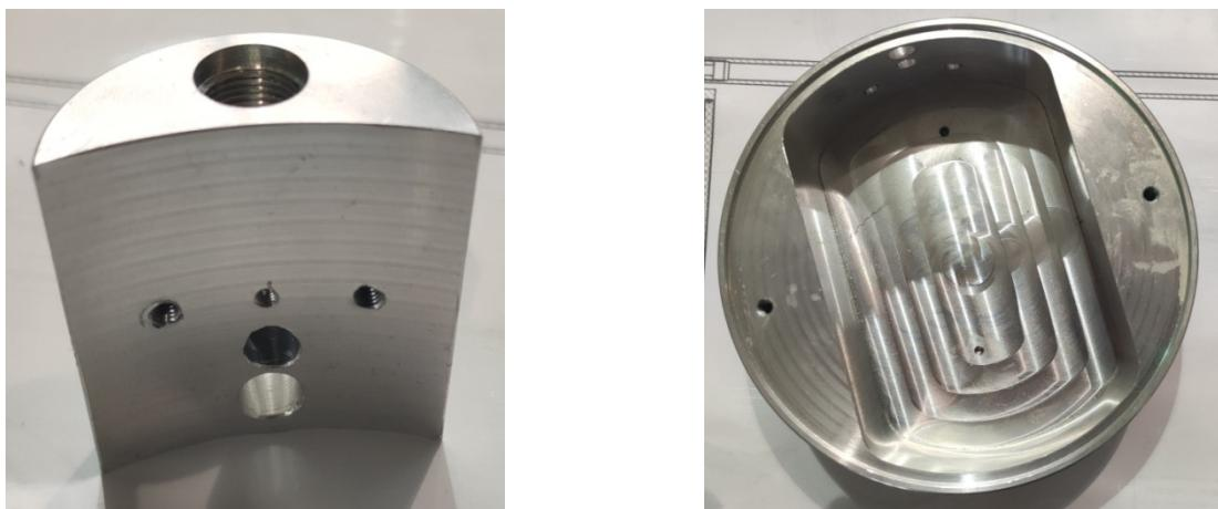
Slika 4.37. Spojni element (lijevo) i postolje (desno)
