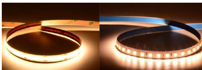
Slika 2.11. COB na LED traci (lijevo) i SMD čip (desno) [22]
