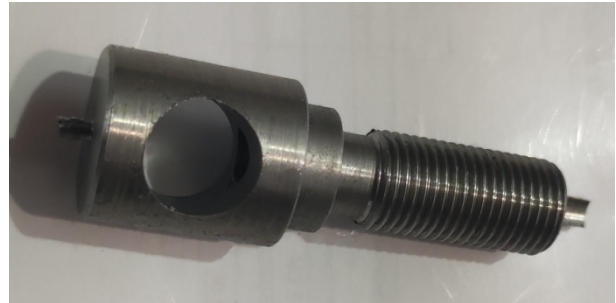
Slika 4.31. Okretni vijak - gotovi komad
