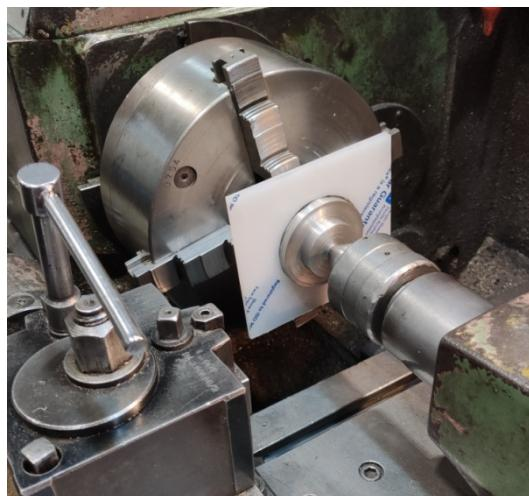
Slika 3.37. Sirovi komad akrilnog stakla u napravi
