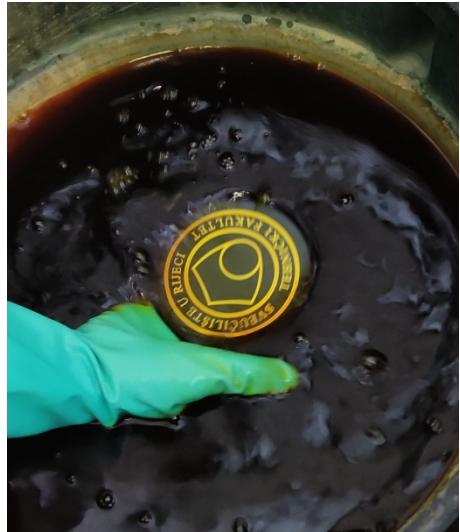
Slika 4.41. Gotovo graviranje (lijevo); kromatiranje gravure (desno)
