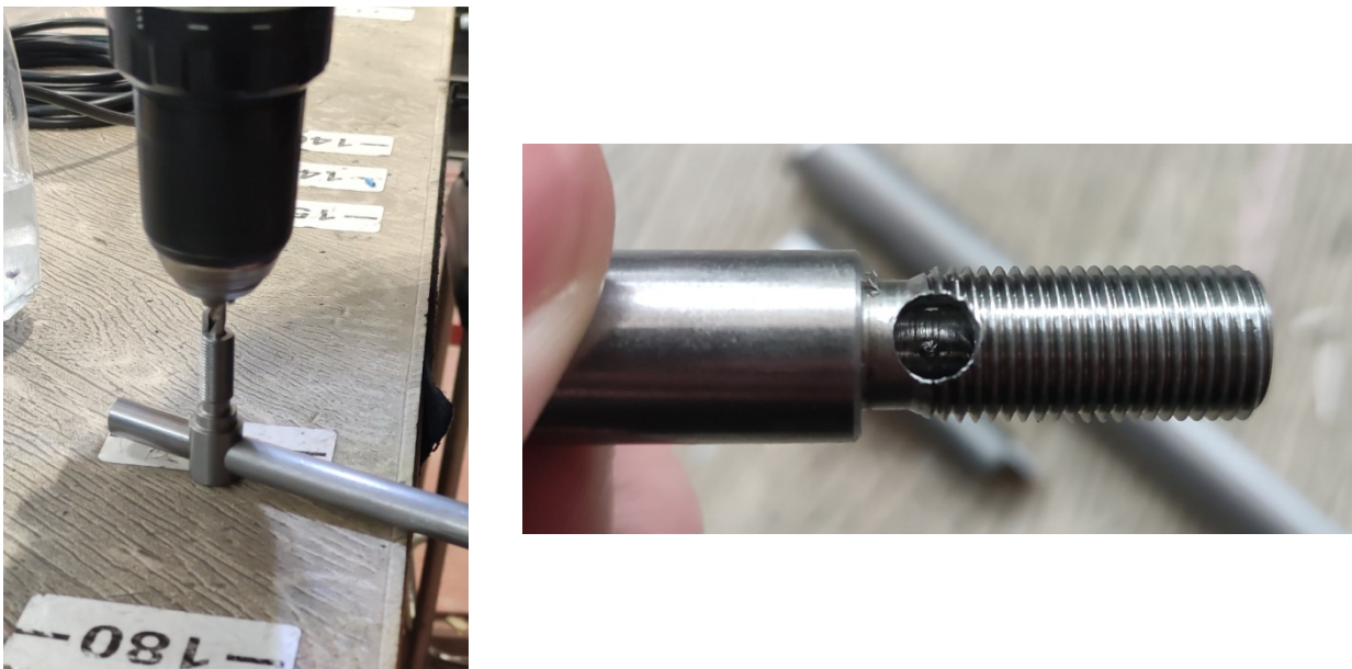
Slika 4.33. Bušenje spojnog vijka (lijevo); spojni vijak (desno)
