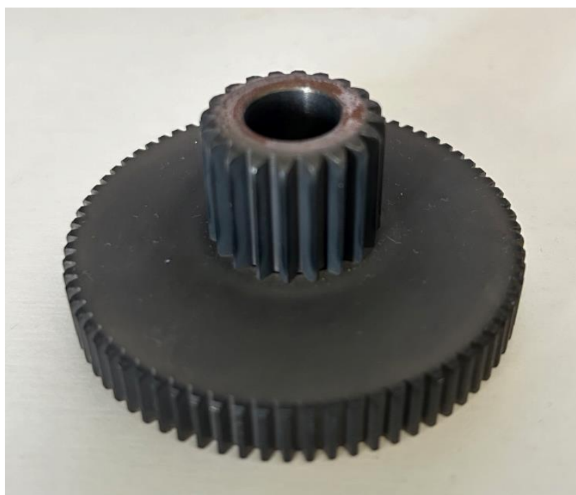
Slika 4.2 Zupčanik – m1; z20/m0,9; z75 (proizvod D)
