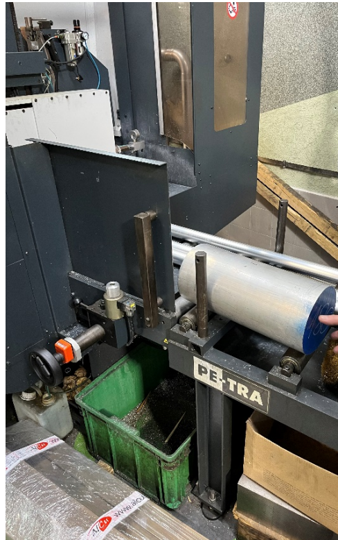
Slika 5.1. Postavljanje šipke na pilu
