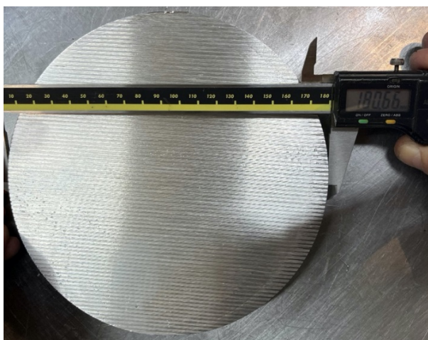
Slika 5.5. Kontrola dimenzije promjera šipke
