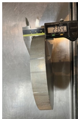
Slika 5.6. Kontrola dimenzije dužine prepiljene šipke
