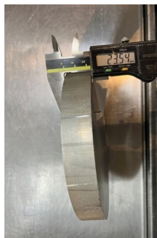
Slika 5.6. Kontrola dimenzije dužine prepiljene šipke
