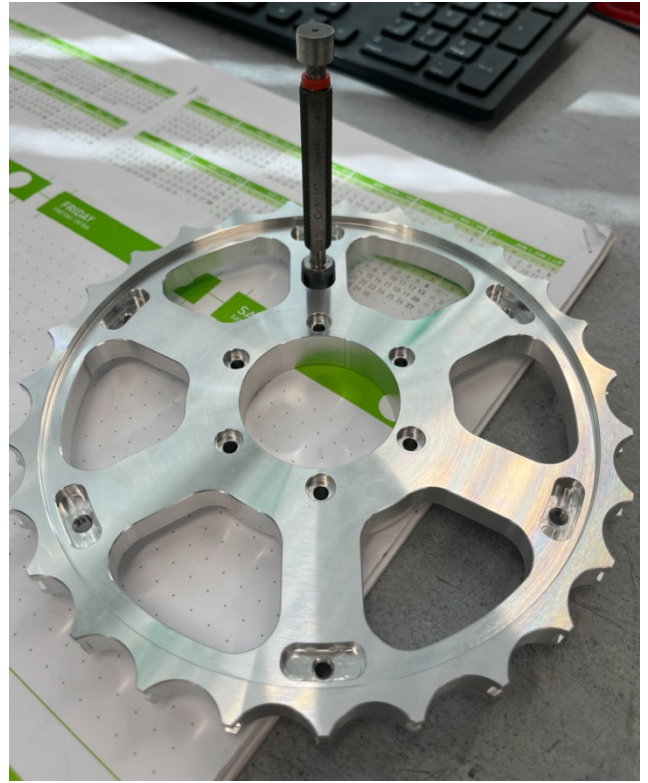
Slika 5.78. Završna kontrola pomoću kontrolnika 10H7
