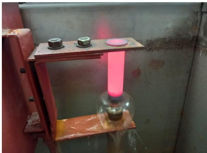
Slika 7.5. Čeono gašenje uzorka na početku pokusa
