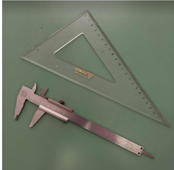
Slika 7.10. Ravnalo i pomično mjerilo kojim se mjeri udaljenost od čela uzorka
