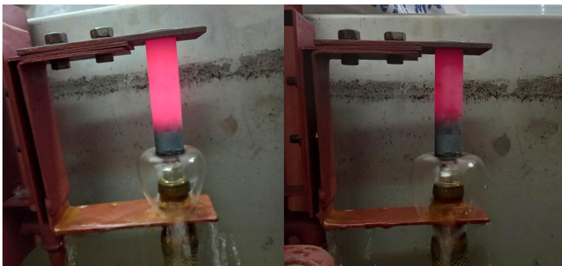
Slika 7.6. Stanje uzorka nakon 1 minute i 2 minute gašenja
