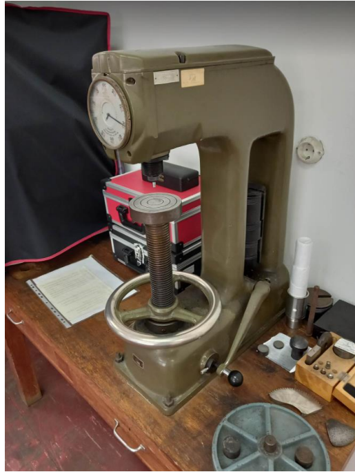
Slika 7.9. Tvrdomjer za ispitivanje tvrdoće Rockwellovom metodom
