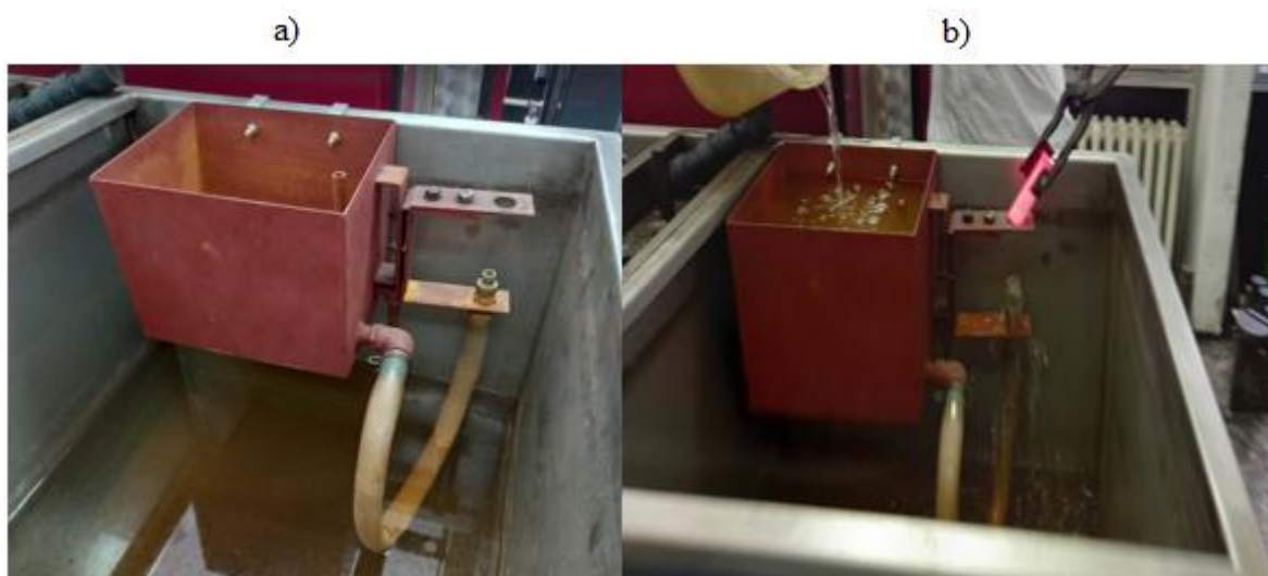
Slika 7.4. a) Naprava za Jominyjev pokus; b) Trenutak stavljanja uzorka u napravu
