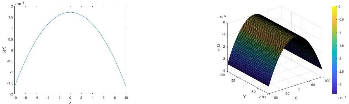
Slika 4.10. Prikaz rješenja električnog potencijala  $\varphi(z)$ . Izvor: Izrada autora
