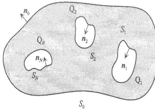
*Slika 4.5. Sustav statičkog električnog polja. Izvor: [15]*
