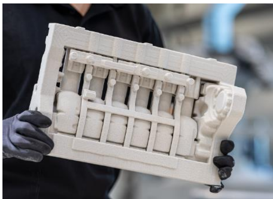
Slika 2.1 Prikaz jezgre kalupa [2]
