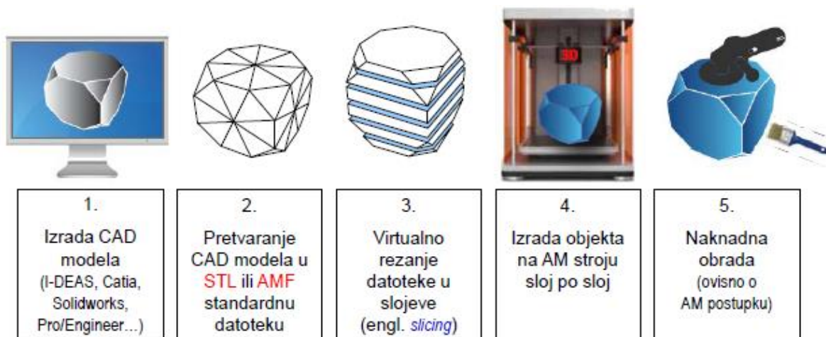
Slika 5.1 Koraci aditivne proizvodnje [14]
