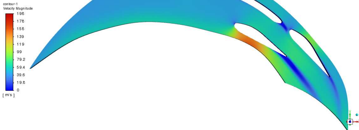
Slika 7.3 Konture brzina za 5° od maksimalnog položaja privodećih lopatica
