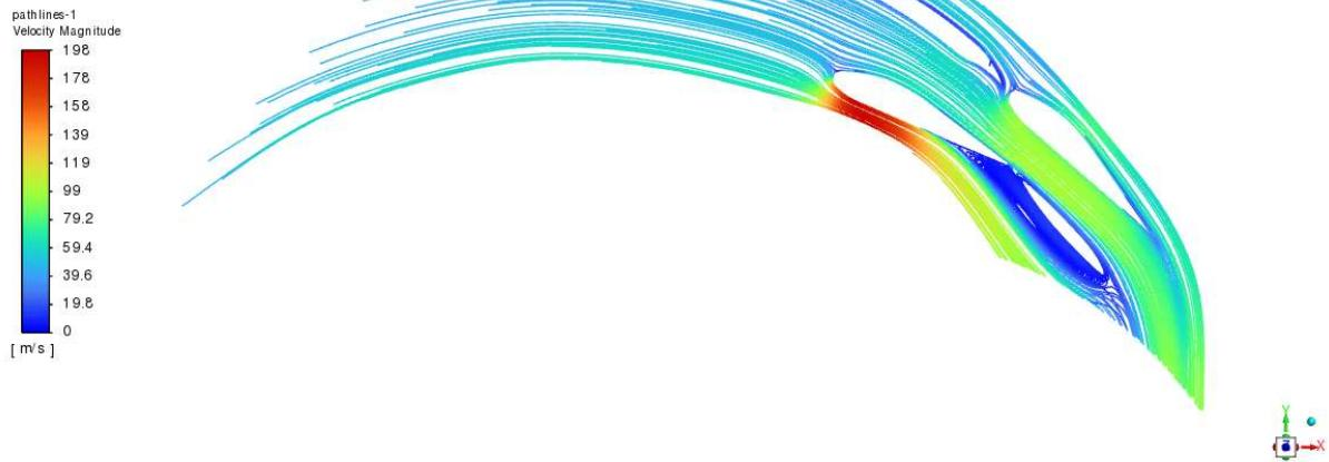
Slika 7.19 Strujnice brzina za  $10^\circ$  od maksimalnog položaja privodećih lopatica
